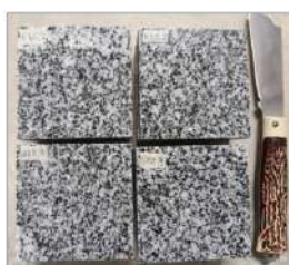
Figura 2: Amostras de Granito Cinza Andorinha de granulação fina com cristais de biotita disseminados
