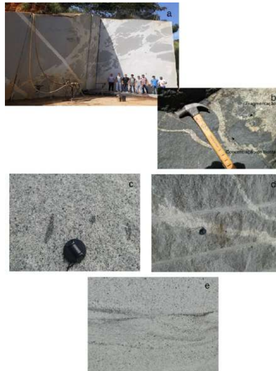
Prancha 1: Diferenças texturais ( defeitos ) encontradas no Granito Cinza Andorinha.
