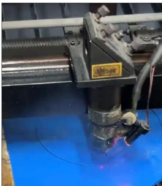
Figura 11: Equipamento CNC utilizado no corte de poliondas.
