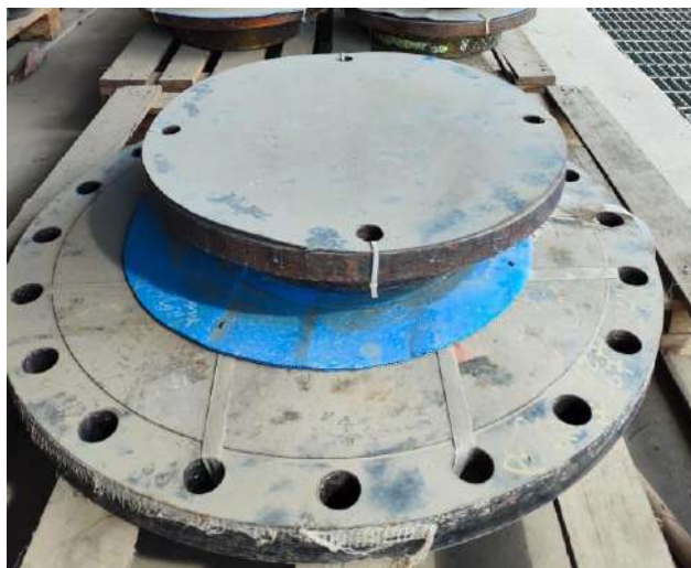
Figura 13: Protetores realizados manualmente, instalados nos flanges.
